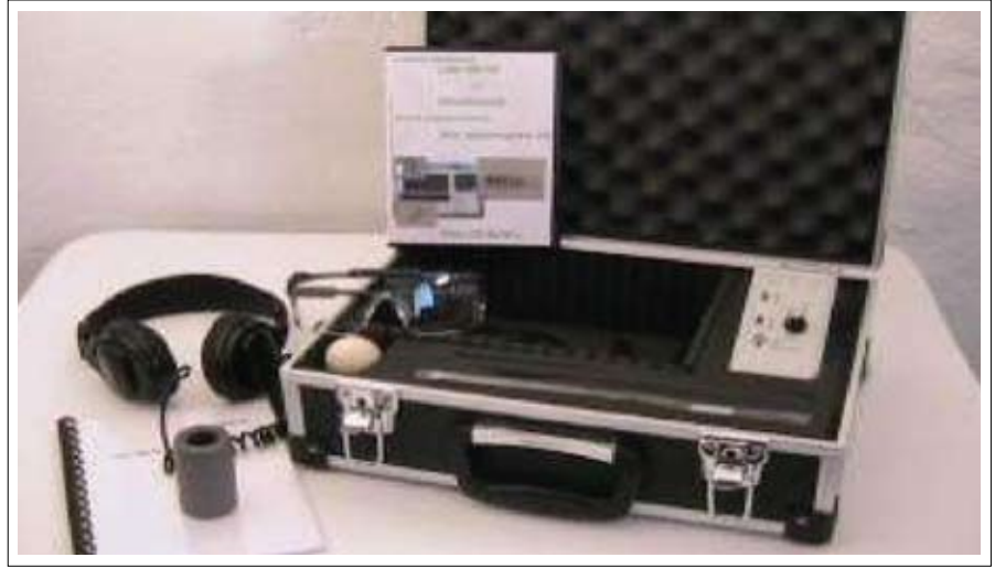
شكل رقم (١٣) أجهزة حديثة متطورة تستخدم للكشف المبكر عن سوسة النخيل الحمراء بواسطة السمع
